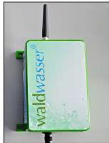
Das „Kastl“: Die Waterbox liefert einmal täglich die Stundenwerte des Wasserverbrauchs. – Fs: gs
